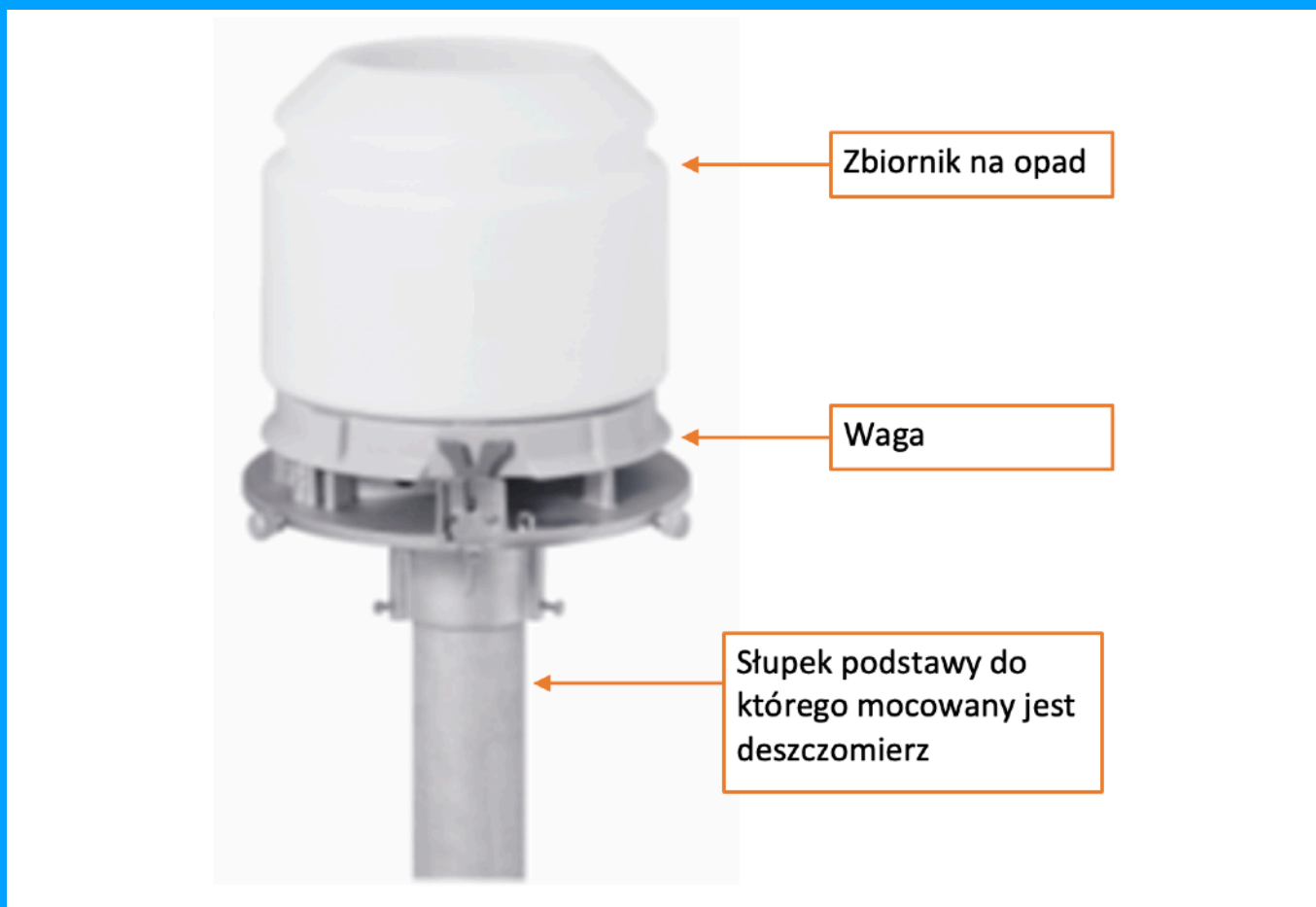
Zdjęcie 2. Widok deszczomierza wagowego po zdjęciu pokrywy. Widać duży zbiornik na opad. Bezpośrednio pod zbiornikiem znajduje się waga.
