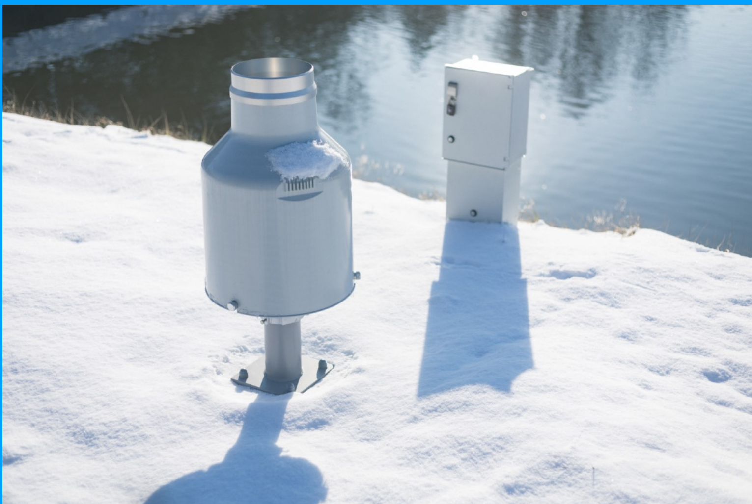
Zdjęcie 1. Przykład deszczomierza wagowego o powierzchni wlotu 400cm 2 zainstalowany przez PM Ecology w Gdańsku.
