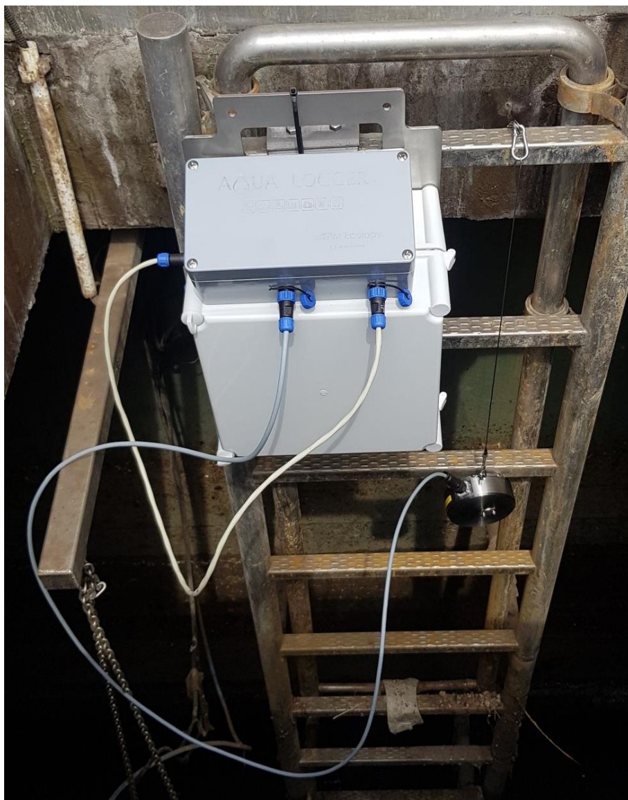
Rys. 5. Przykładowy sposób montażu stacji pomiarowej
